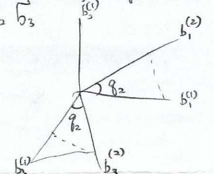
$$\begin{aligned} \vec{a}_3 &= cq_1 sq_2 \vec{b}_2^{(1)} + cq_1 b_3^{(1)} \\ &= sq_1 cq_3 \vec{b}_2 - sq_1 sq_3 \vec{b}_3 \\ &\quad + cq_1 cq_2 \vec{b}_3^{(2)} - cq_1 sq_2 \vec{b}_1^{(2)} \\ &= sq_1 cq_3 \vec{b}_2 - sq_1 sq_3 \vec{b}_3 + cq_1 cq_2 sq_3 \vec{b}_2 \\ &\quad + cq_1 cq_2 cq_3 \vec{b}_3 - cq_1 sq_2 \vec{b}_1 \end{aligned}$$
